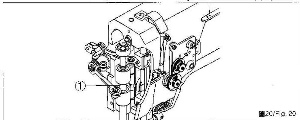
3. Согласование челноков. Ослабьте два крепежных винта (3) и выполните настройку левого и правого челнока, как показано на рисунке 19. После этого ослабьте два крепежных винта (5), и отрегулируйте положение зубчатых колес (4). По завершению регулировки, затяните крепежные винты (3) и (5). (Рис. 19).
